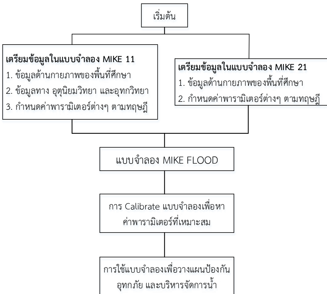
รูปที่ 4.2-2 ขั้นตอนการใช้งานแบบจำลองทางคณิตศาสตร์
