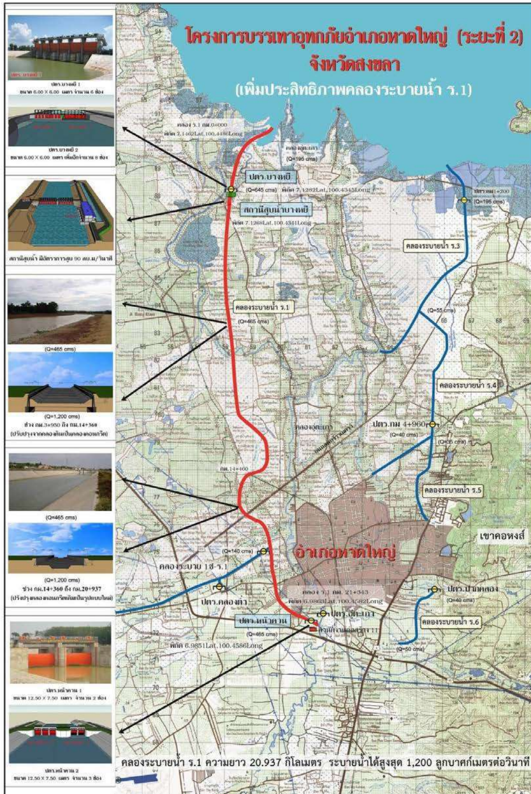
รูปที่ 4.3-5 ตำแหน่งที่ตั้งและรายละเอียดโครงการบรรเทาอุทกภัยเมืองหาดใหญ่ระยะที่ 2
